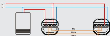
Схема подключения сетевой системы панелей с S-BUS (RS 485)
