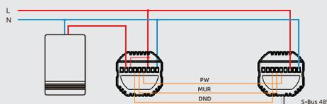
Схема подключения сетевой беспроводной системы панелей
